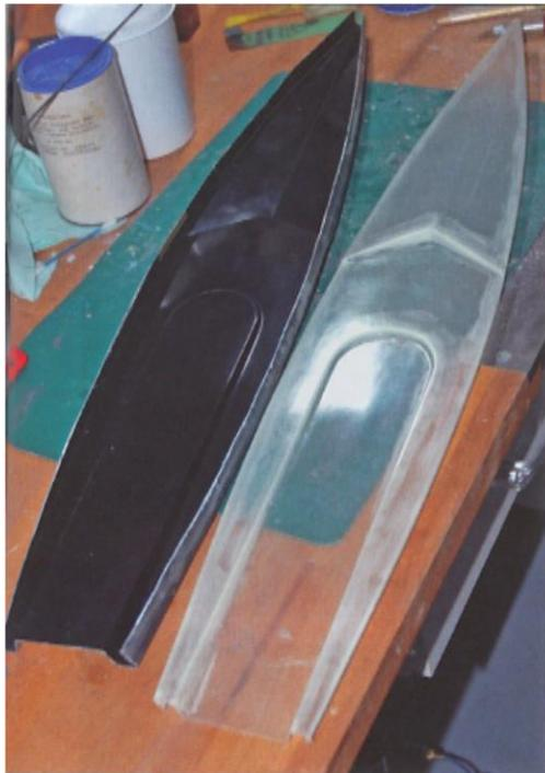
**Bild links: Das Deck wird wegen der Hinterschneidungen in einer etwas flexiblen Negativform laminiert**
