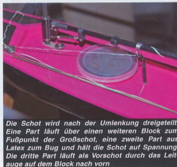
Die Schot wird nach der Umlenkung dreigeteilt. Eine Part läuft über einen weiteren Block zum Fußpunkt der Großschot, eine zweite Part aus Latex zum Bug und hält die Schot auf Spannung. Die dritte Part läuft als Vorschot durch das Leitauge auf dem Block nach vorn
