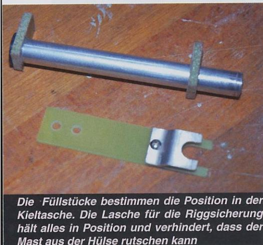
**Die Füllstücke bestimmen die Position in der Kieltasche. Die Lasche für die Riggsicherung hält alles in Position und verhindert, dass der Mast aus der Hülse rutschen kann**
