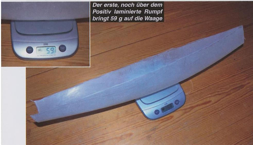
Der erste, noch über dem Positiv laminierte Rumpf bringt 59 g auf die Waage
