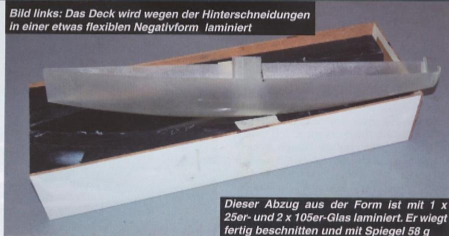
**Dieser Abzug aus der Form ist mit 1 x 25er- und 2 x 105er-Glas laminiert. Er wiegt fertig beschnitten und mit Spiegel 58 g**
