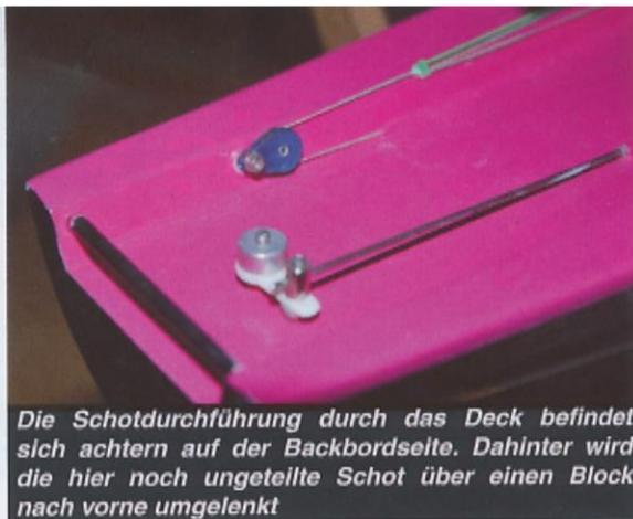
Die Schotdurchführung durch das Deck befindet sich achtern auf der Backbordseite. Dahinter wird die hier noch ungeteilte Schot über einen Block nach vorne umgelenkt
