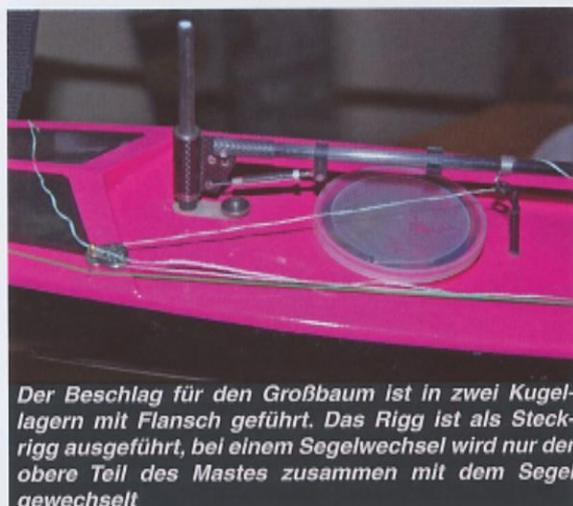
Der Beschlag für den Großbaum ist in zwei Kugellagern mit Flansch geführt. Das Rigg ist als Steckrigg ausgeführt, bei einem Segelwechsel wird nur der obere Teil des Mastes zusammen mit dem Segel gewechselt
