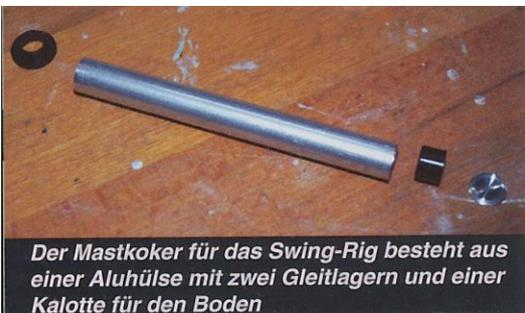
**Der Mastkoker für das Swing-Rig besteht aus einer Aluhülse mit zwei Gleitlagern und einer Kalotte für den Boden**
