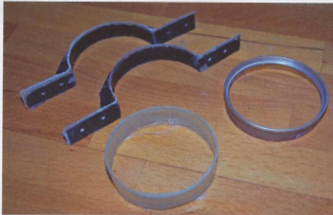
**Der von der Dose abgetrennte Blechring (vorne rechts), der fertig laminierte Ring (vorne links) und die beiden Formhälften**
