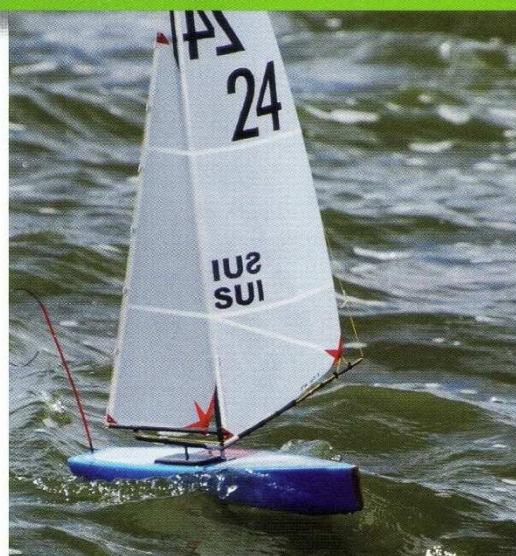
Bei rechtzeitigem Einsatz von kleineren Riggs blieben auch Swingrigg-Boote beherrschbar: die „Newnip“ von Andreas Schellenbaum (SUI 24)
