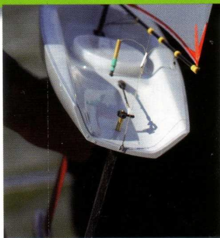
... und den Knick im Achterschiff. Beides sind Anleihen aus dem Großbootsbau
