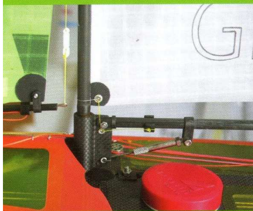
Das Gegenteil zeigte Arne Semken auf seiner „Coriolis“. Sein Lümmelbeschlag war ein aufwändiges, kugelgelagertes Karbonteil (Foto: © Arne Semken)
