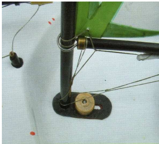
Sehr puristisch wirkten die Beschläge der niederländischen Boote. Es reichen offenbar auch einfache Drahtösen zum Siegen (Foto: © Gerrit de Wilde)
