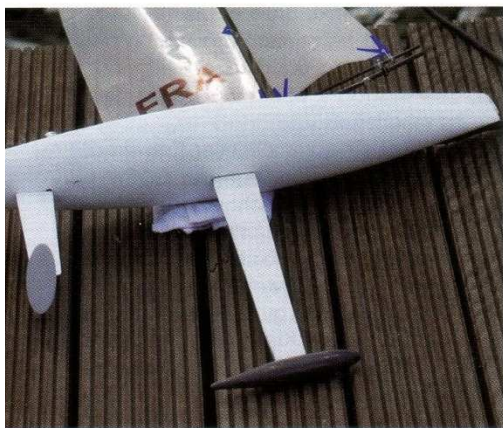
Die aktuelle Konstruktion von Pascal Delapierre (FRA 13) ist mit einer Art Höhenruder ausgerüstet, um Kopfstände zu vermeiden
