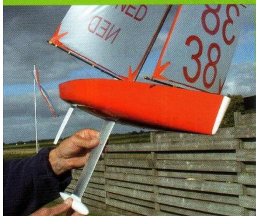
Die „RGForce“ unterscheidet sich von den meisten anderen Designs insbesondere durch den flachen Boden ... (Foto: © Gerrit de Wilde)
